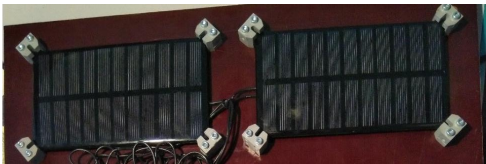
29. ábra: Redundáns felépítésű, fotovoltaikus feszültségforrás modellje
